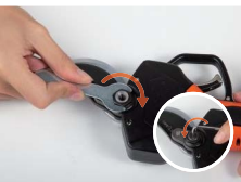
11. Installare il dado di bloccaggio grande e il dado di bloccaggio piccolo.
