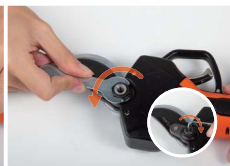
2. Allentare il dado di bloccaggio piccolo in senso orario e togliere la rondella di arresto. Allentare il dado di bloccaggio grande in senso antiorario.
