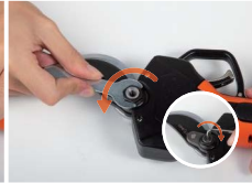
2. Afloje la tuerca de bloqueo pequeña en el sentido de las agujas del reloj y retire la arandela de tope. Afloje la tuerca de bloqueo grande en el sentido contrario a las agujas del reloj.
