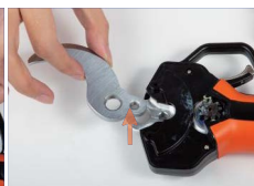
6. Rimuovere la lama inferiore.
