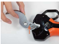
6. Retirer la lame inférieure.
