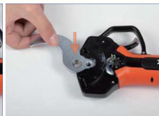
7. Installieren Sie das untere Blatt.
