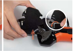
4. Afloje el tornillo de la tapa y retírela.
