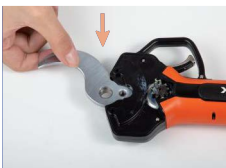
7. Installer la lame inférieure.
