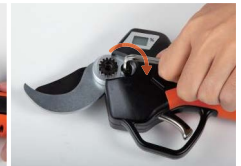
12. Instale el tornillo pequeño.
