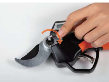
3. Allentare la vite grande con la chiave in senso orario.
