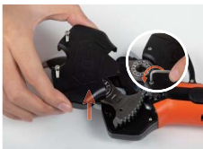
4. Desserrer la vis du bouchon et retirer le bouchon.
