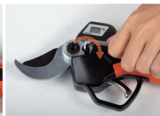
12. Installare la vite piccola.
