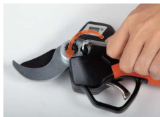
1. Desserrer la petite vis à l'aide d'une clé dans le sens inverse des aiguilles d'une montre.
