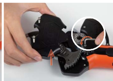
4. Allentare la vite del tappo e rimuoverlo.
