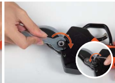
11. Instale la contratuercas grande y la tuerca de seguridad pequeña.
