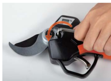
1. Allentare la vite piccola con la chiave in senso antiorario.
