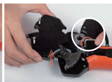
4. Lösen Sie die Schraube der Kappe und Entfernen Sie die Kappe.
